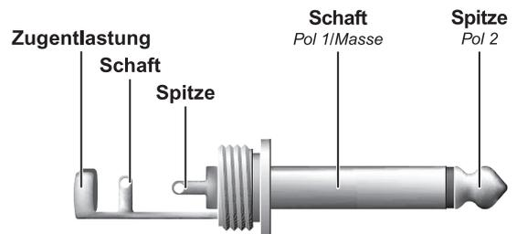
Der Fußtaster verbindet kurzzeitig die beiden Pole
