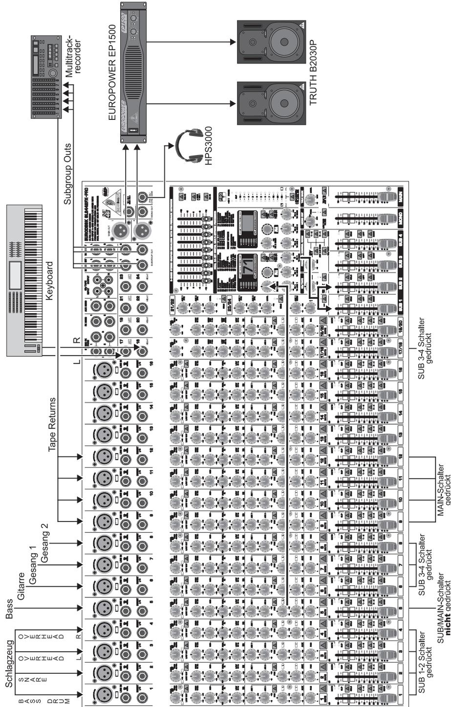
Abb. 4.1: Mischpultverkabelung im Studiobetrieb
