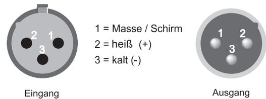
Bei unsymmetrischem Betrieb müssen Pin 1 und Pin 3 gebrückt werden.
