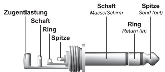
Verbinden Sie den Insert Send mit dem Eingang und den Insert Return mit dem Ausgang des Effektgeräts.
