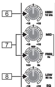
Abb. 2.2: Klangregelung der Eingangskanäle
