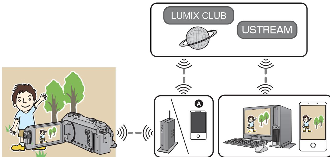
**A** Sie können Videos auch live senden, indem Sie dieses Gerät mit einem Smartphone verbinden, das Tethering unterstützt.
